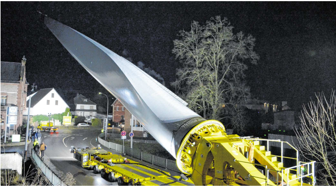
Spektakulärer Transport: Mit einem Selbstfahrer wurde am Mittwochabend ein Rotorblatt für den Windpark „Kornberg/Dreimärker“ durch Hardheim manövriert.
